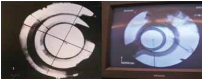
Fig.29: Contrôle radioscopique de la descente de l'électrode
